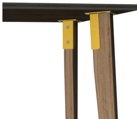
Rys. 3 Detal – uchwyty profilowane nóg drewnianych
