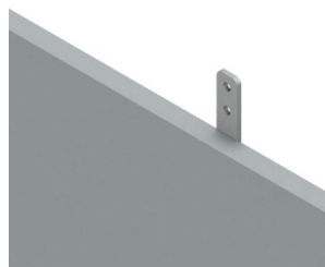
Rys. 6 Detal blendy – płaskownik montażowy .
