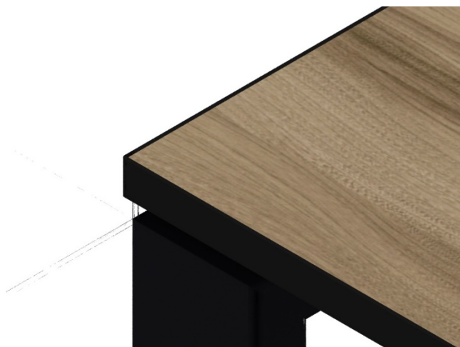
Rys. 5 Stół – detal – ABS blatu w kontrastującym kolorze
