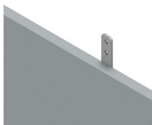
Rys. 7 Detal blendy – płaskownik montażowy .
