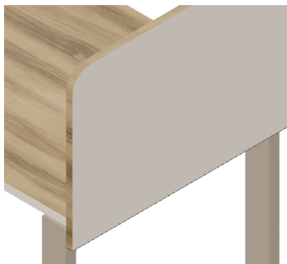
Rys. 6 Przegroda – detal – ABS przegrody w kontrastującym kolorze – kolorze blatu biurka
