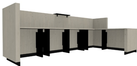
Rys. 3 Lada – wnętrze – nogi wsporcze i nadstawka
