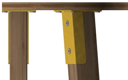
Rys. 3 Detal – uchwyty profilowane nóg drewnianych
